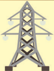
ระบบไฟฟ้า : จัดพอร์ต 2 สาย, จ่ายกำลังไฟ 115 กิโลวัตต์
